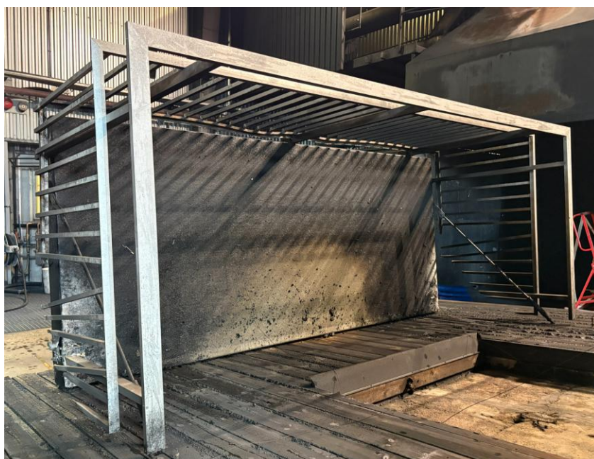
Figur 16. Bild på ovansidan av den nedre balkongplattan efter prov. Inre delar av balkongplattan är inte brandpåverkad. Räcket har smält närmast branden men inte i övrigt.
