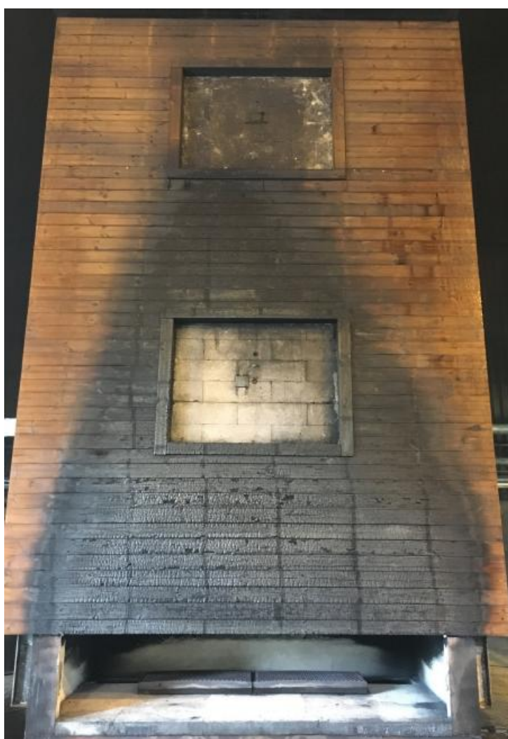
Figur 2. Resultat från tidigare fasadbrandprovning enligt SP FIRE 105 med fasadmateriäl som bedömts likvärdigt som det som använts i den aktuella provningen.
