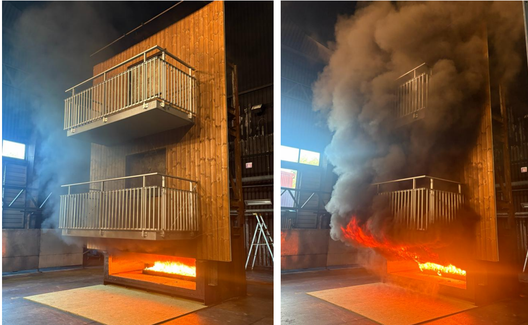
Figur 9. (t.v.) Bild efter en minut i provningen. (t.h.) Bild efter fyra minuter av provningen. Flammor börjar slå ut mot balkongen.
