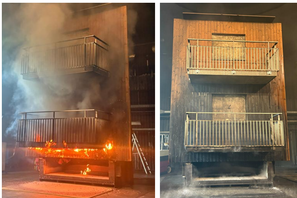
Figur 13. (t.v.) Bild efter 15 minuter av provningen när bränslet är slut. (t.h.) Bild efter helt avslutat prov.
