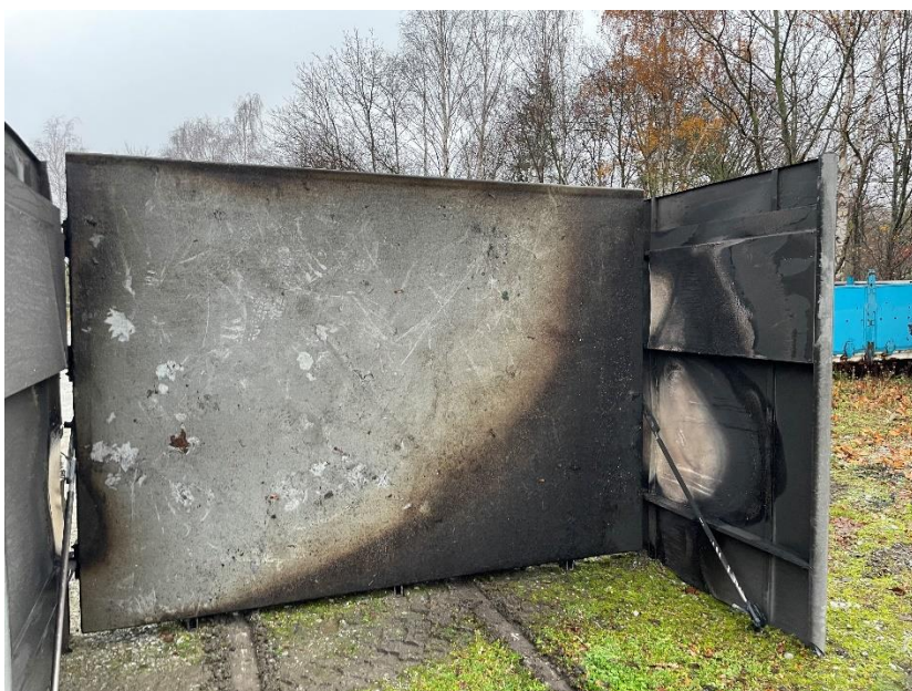
Figur 25. Ovansidan balkongplatta efter försöket.
