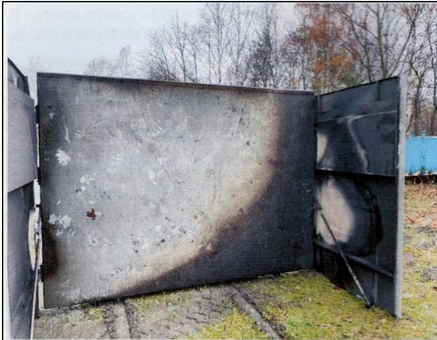
Figur 25. Ovasidan balkongplatta efter försöket.
