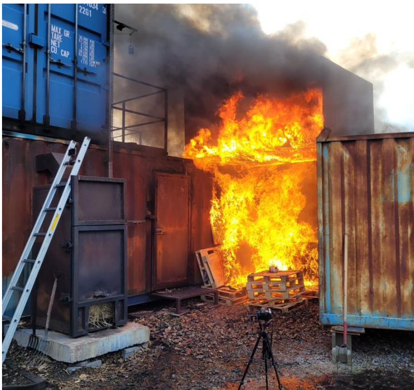
Figur 2. Brandtest balkongplatta, cirka 4 minuter efter brandstart.
